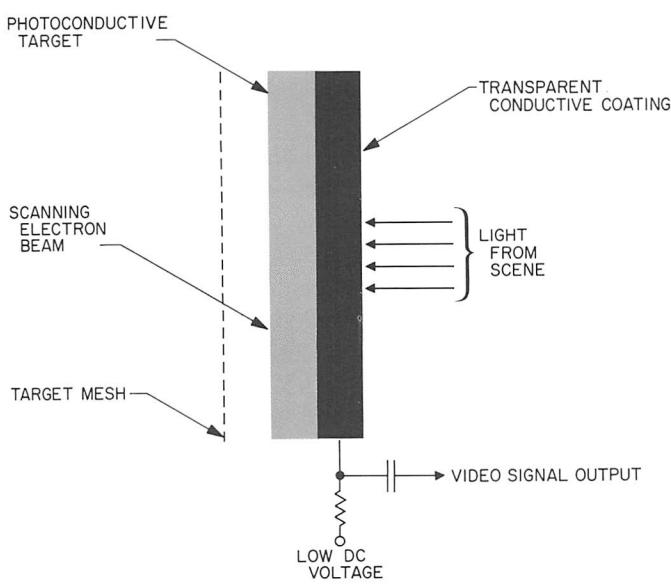
**Fig. II-9. Vidicon functional diagram**
